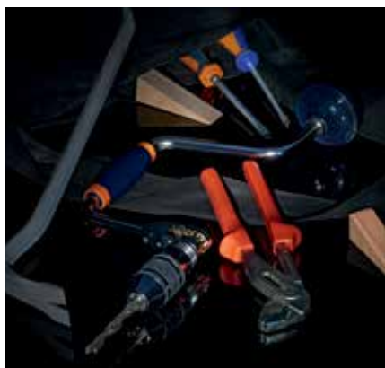
Slika desno: Alat za provalu prema RC 3 sigurnosnoj klasi
